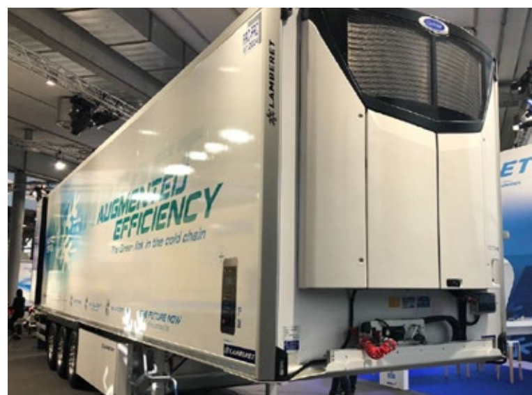
Caixa e portas do sistema de refrigeração para a Carrier produzido em SMC desde Leça do Balio.
