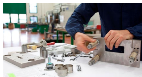
Montagem de um cortante nas oficinas BIGTOWER grupo PRIMANOTA
