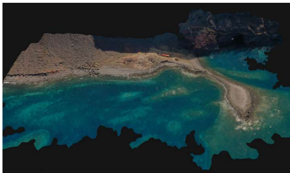
Modelo tridimensional de zona costeira na ilha da Deserta Grande, utilizado em mapeamento de habitats recorrendo a drones e veículos de superfícies tripulados remotamente, João Monteiro / MARE-Madeira
