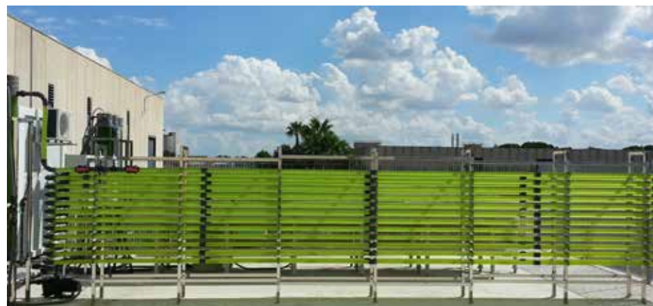
Fotobiorreator tubular com produção da microalga Chlorella vulgaris .
