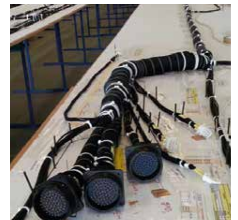
Cablagem para aplicação ferroviária
