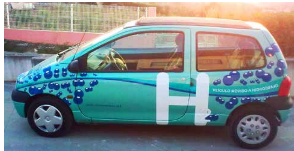
Twingo, o veículo ligeiro convertido em 2008 para funcionar com hidrogénio.
